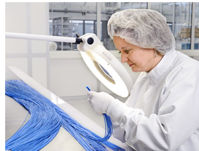
Der neue Reinraum der Klasse 8 ermöglicht die Fertigung von Produkten unter kontrollierten Bedingungen.
