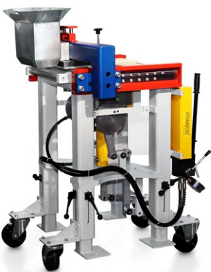
Sieben Tonnen Presskraft besitzt die mechanische Presse. Mit ihr lassen sich Formsteine aus Lehm in jeweils nur vier Minuten herstellen.
