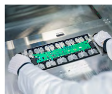
Ein Batteriemodul wird auf die Verschaltung durch Laserschweißen vorbereitet.
